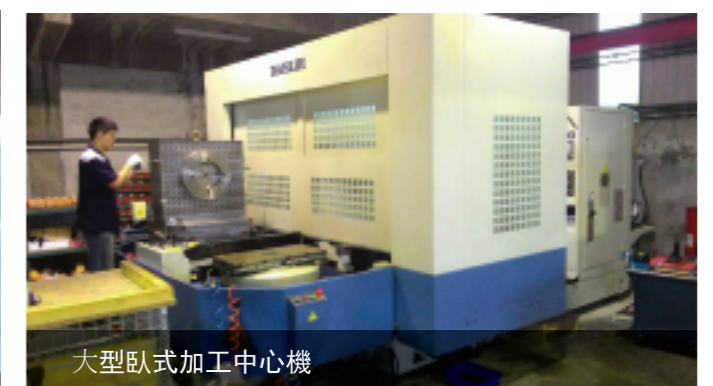
臥式加工中心機:閥體軸孔精密加工
